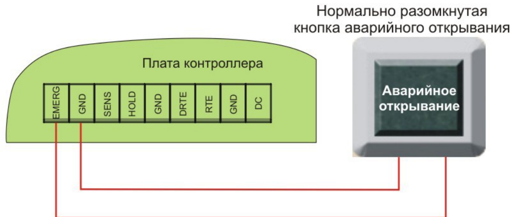
Рисунок 16. Подключение кнопки аварийного выхода к одному контроллеру
