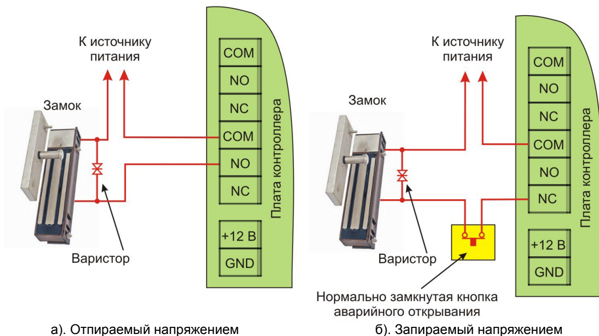
Рисунок 6. Подключение замков к контроллеру
