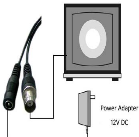
Рис. 6.1.1. Коммутация разъемов видеокамеры
