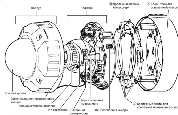
Корпус Камера Крепежная планка (аксессуар) Кронштейн для основания (аксессуар) Крышка купола Светоизоляционное резиновое кольцо Кольцо установки наклона ИК светодиод Наклонная поверхность Винт крепления камеры Крепежные винты для крепежной планки (аксессуар)
