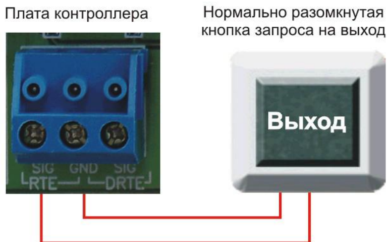
Рисунок 9. Схема подключения кнопки запроса на выход.
