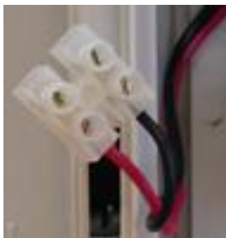
Рисунок 12. Кабель для подключения замка к источнику питания.
