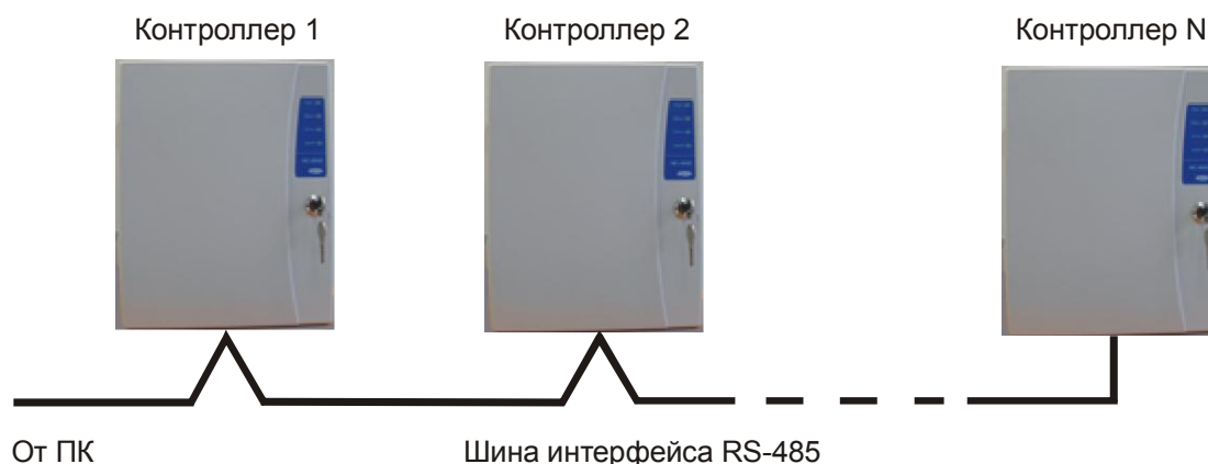
а). Соединение контроллеров по топологии «Шина».
