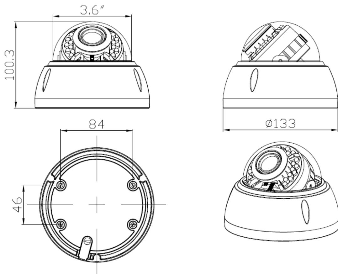
Монтаж видеокамеры необходимо производить на твёрдой устойчивой поверхности. Во избежание попадания влаги на разъёмы видеокамеры, рекомендуем использовать коммутационные коробки, со степенью защиты IP66.
