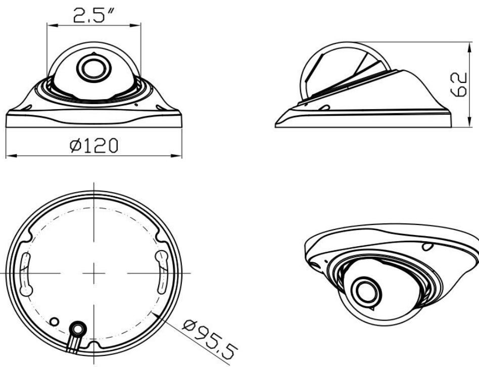
Монтаж видеокамеры необходимо производить на твёрдой устойчивой поверхности. Во избежание попадания влаги на разъёмы видеокамеры, рекомендуем использовать коммутационные коробки, со степенью защиты IP66.
