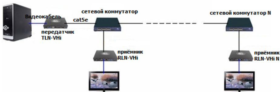
Рис.4 Схема подключения передатчика TLN-VHi и приемников RLN-VHi каскадом.
