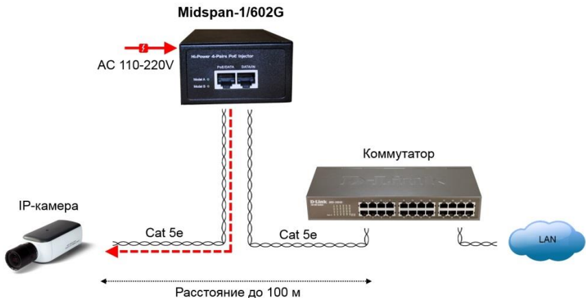
Рис. 3. Схема подключения инжектора Midspan-1/602G
