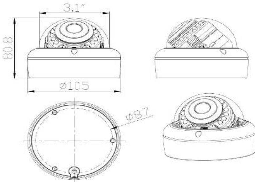
Монтаж видеокамеры необходимо производить на твёрдой устойчивой поверхности. Во избежание попадания влаги на разъёмы видеокамеры, рекомендуем использовать коммутационные коробки, со степенью защиты IP66.
