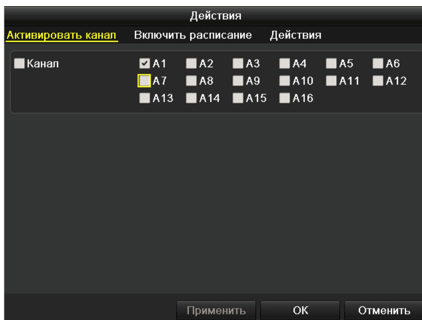
Рис. 8.3 Установка камер, реагирующих на тревогу
