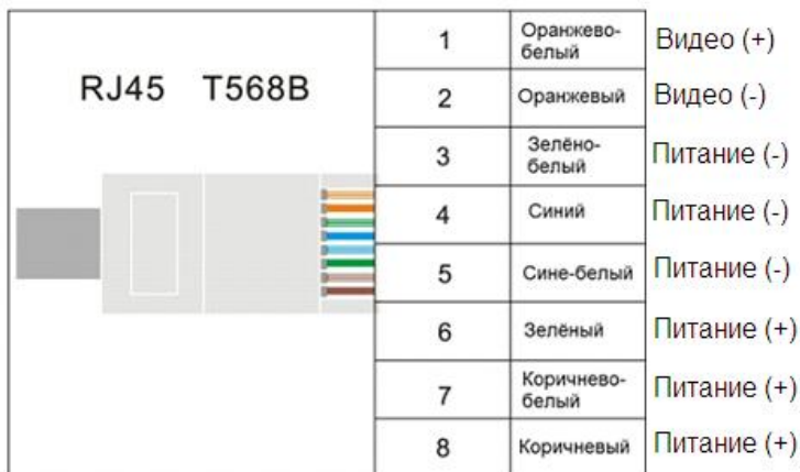
Рис.5 Распиновка разъемов RJ45
