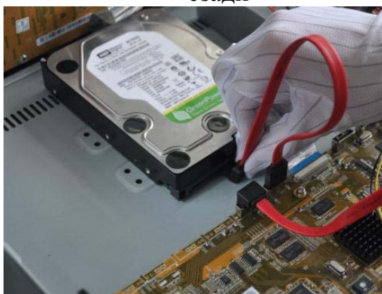
Подключите кабель данных и питания к HDD
