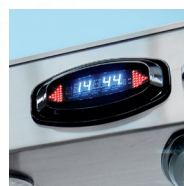
Двусторонний указатель направления движения со светодиодами повышенной светоотдачи
