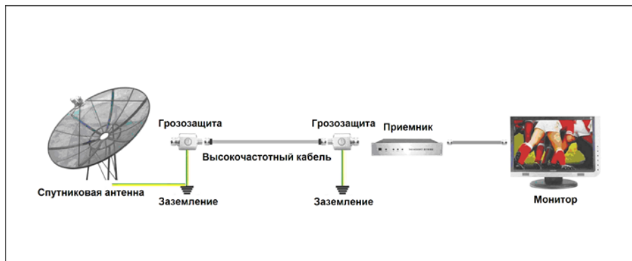
Рис.3 Структурная схема подключения устройств грозозащиты
