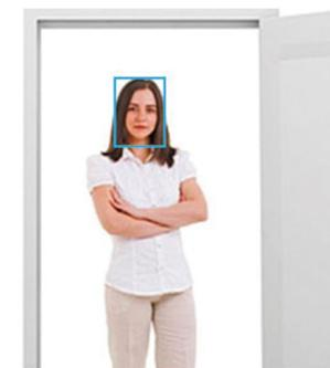
Счетчик пикселей, которым оснащены камеры AXIS M11-L, позволяет установщику убедиться в том, что разрешение объекта в пикселях отвечает нормативным требованиям или требованиям заказчика, например для идентификации по изображению лица проходящих людей.
