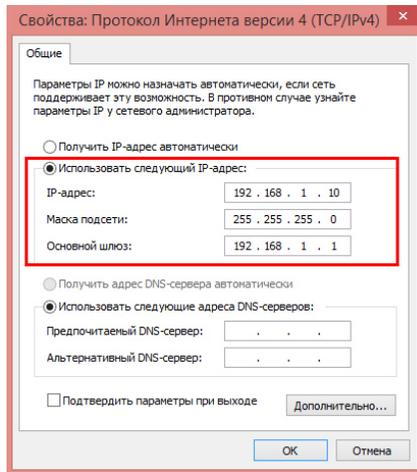
В поле IP-адрес ввести адрес одной подсети с IP-камерой. Например, если камера имеет IP-адрес 192.168.1.18, то сетевому адаптеру ПК можно назначить IP-адрес, к примеру, 192.168.1.1, маска подсети по умолчанию 255.255.255.0.
