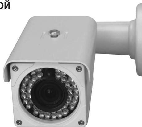
IP-камера STC-IPM3697A использует 1/2.8" 3-мегапиксельную КМОП-матрицу Sony Exmor™. Разрешение изображения QXGA (2048x1536) и точность цветопередачи позволяют применять STC-IPM3697A на объектах с повышенными требованиями к качеству видеосигнала. Наличие встроенного обогревателя и ИК-подсветки обеспечивает широкую сферу применения камер, как внутри, так и вне помещений.
