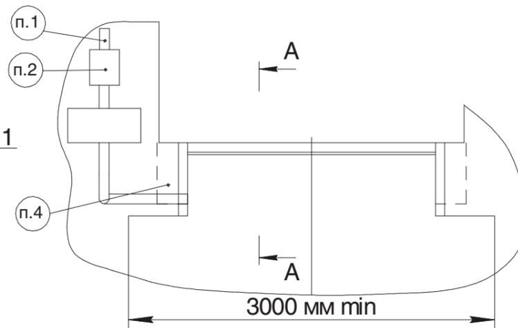
На данном эскизе изображена схема подготовки приямка и установки закладных элементов под уравнильную платформу с поворотной аппаратурой консольного типа длиной 2500мм шириной 2000мм и высотой 600мм при использовании автомобилей, имеющих встроенный лифт
