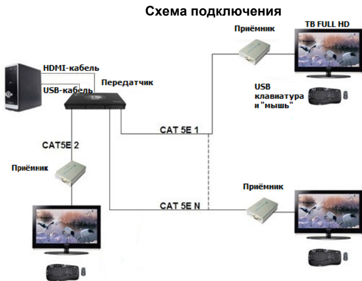
Рис.7 Схема подключения передатчика TA-Hi07/ TA-Hi15 и приемника RA-Hi/1
