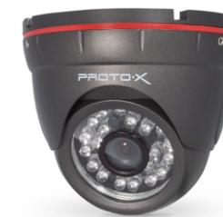
Купольная AHD видеокамера Proto AHD-L13F36IR с фиксированным 3,6 мм объективом и прогрессивной системой сканирования выполнена по новейшей технологии AHD и оснащена новейшим ISP чипом NVP2431H и 1.3Мр CMOS матрицей 1/2.8" SONY IMX238, которые дают возможность ведения видеосъемки с высокой чувствительностью и отличной цветопередачей в разрешении 960P (1280x960) и передачи неискаженного видеопотока.
