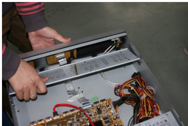
Рис.2.10. Монтаж пластины для установки дополнительных HDD
