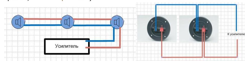
Если громкоговоритель не замыкающий (конечный) в системе, а является одним из звеньев цепочки, то подключаем к нему входящий и исходящий провод. (предварительно соединив его по цветам **синий с синим, красный с красным**). На задней панели усилителя имеются либо клеммы, либо зажимы для выхода на громкоговорители. Необходимо использовать значения COM (или "0") и 100В. К контакту COM мы подключаем **синий** провод, что идет от громкоговорителей, к контакту со значением 100В - **красный**.
