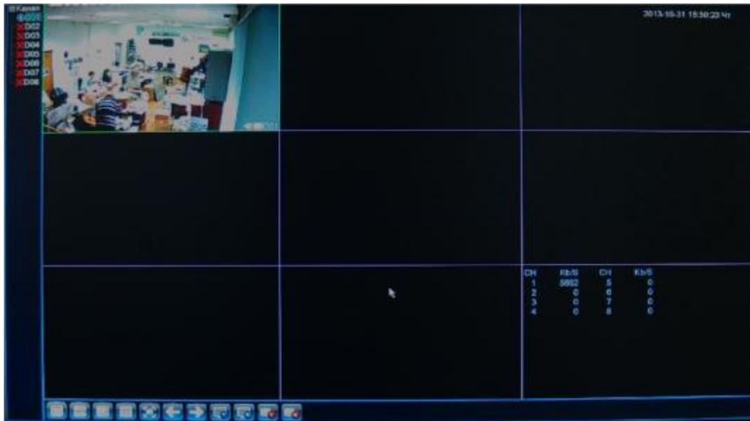
С левой стороны находится список камер, в правом верхнем углу отображается текущая дата и время регистратора, в правом нижнем углу отображается битрейт подключенных камер.
