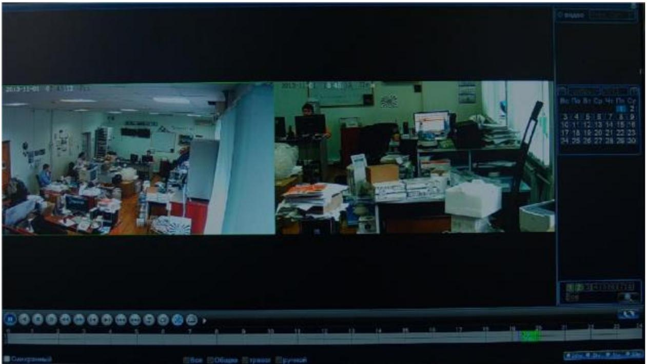
С правой стороны расположен календарь, в котором можно выбрать необходимую дату. Ниже расположена панель выбора камер. На ней цветом выделены выбранные камеры . Для выбора нужных камер (одновременно можно просматривать архив с двух камер 1080р или четырех камер 720р (в зависимости от настроек и типа NVR).
