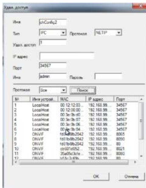
Для добавления найденной камеры выберите камеру в списке найденных, дважды щелкните мышью по камере и введите имя пользователя и пароль камеры, после чего нажмите ОК. Камера появится в списке камер для выбранного канала. Поставьте галочку напротив камеры в списке камер.
