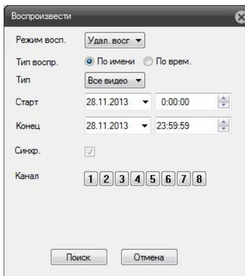
При выборе необходимо выбрать тип записей – все видео, или запись по событиям, дату начала или окончания интервала записи, выбрать один канал записи и нажать **Поиск**.
