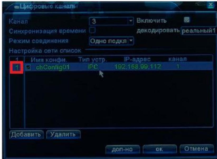
Нажмите **ОК**. Добавленная камера через некоторое время после выхода из меню отобразится на мониторе.
