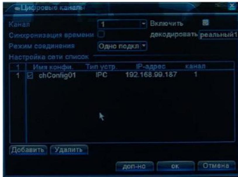
**Канал** – номер канала NVR, к которому привязывается IP-камера. Регистратор BSP-NVR-0802-02 поддерживает до 16 каналов.
