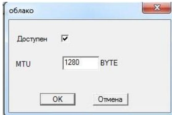
Видеорегистраторы поддерживают облачный сервис <http://xmeye.net>. При включении этой функции видеорегистратор автоматически устанавливает соединение с сайтом <http://xmeye.net>. При этом не требуется никаких настроек роутера, связанных с пробросом портов и наличием выделенного IP адреса.
