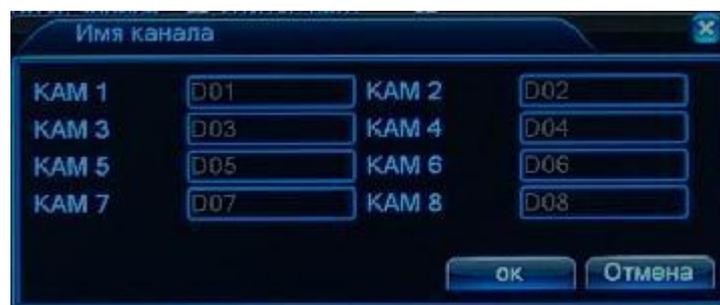
Можно включить отображение времени, отображение имени канала, статуса записи, информацию о битрейте камер, прозрачность меню и разрешение монитора.
