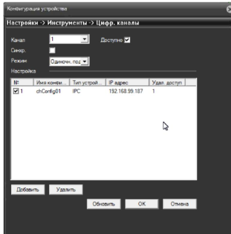
**Канал** – номер канала NVR, к которому привязывается IP-камера. Регистратор BSP-NVR-0802-02 поддерживает до 16 каналов.
