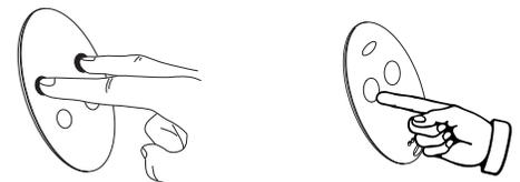
2.7 После окончания записи всех брелков в память радиоприемника, нажмите одновременно два раза кнопки <+> и <->, для выхода из программы.
