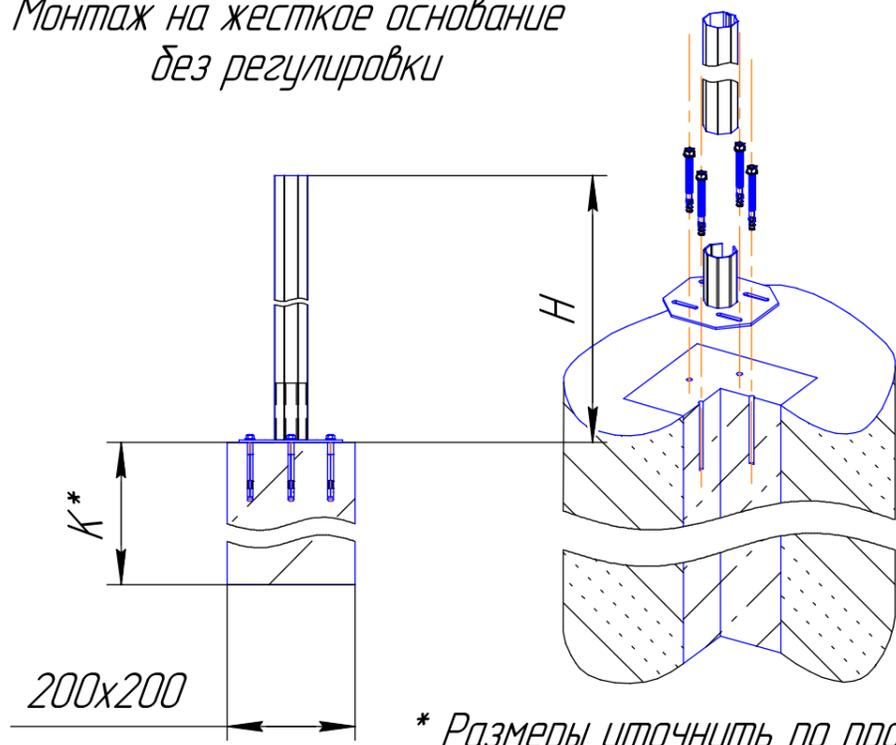
\* Размеры уточнить по проекту. По умолчанию бетонирование на 500 мм
