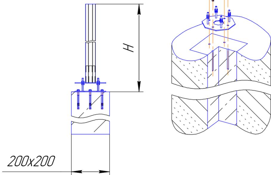
Монтаж с бетонировкой опорного столба
