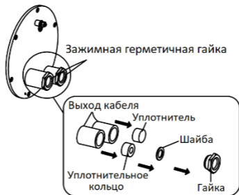
Рисунок 2-8 Демонтаж зажимной герметичной гайки
