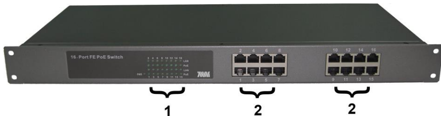
Рис. 1. Коммутатор SW-21600/B, вид спереди
