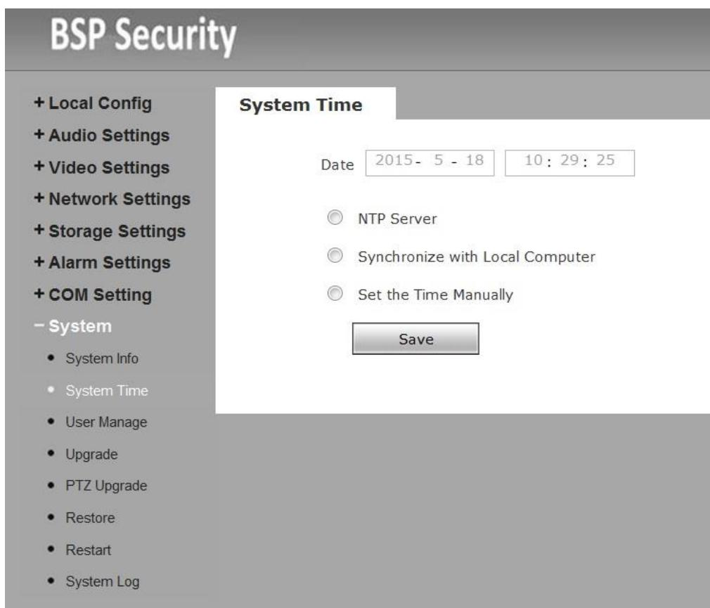
Во вкладке «Restore (Сброс)» и «Restart (Перезагрузка)» можно сбросить камеру на заводские настройки и установить время перезагрузки либо перезагрузить ее в данный момент.
