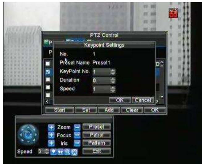
Рис. 6. Меню настройки точек обхода
