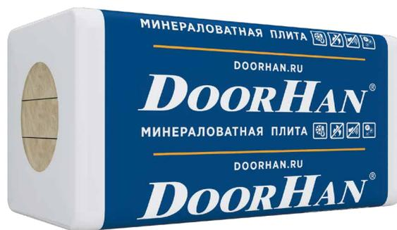
Плиты «Руф В» применяются в качестве верхнего теплоизоляционного слоя в многослойных покрытиях плоских кровель, в том числе при укладке на поверхность без устройства цементно-песчаной стяжки.
