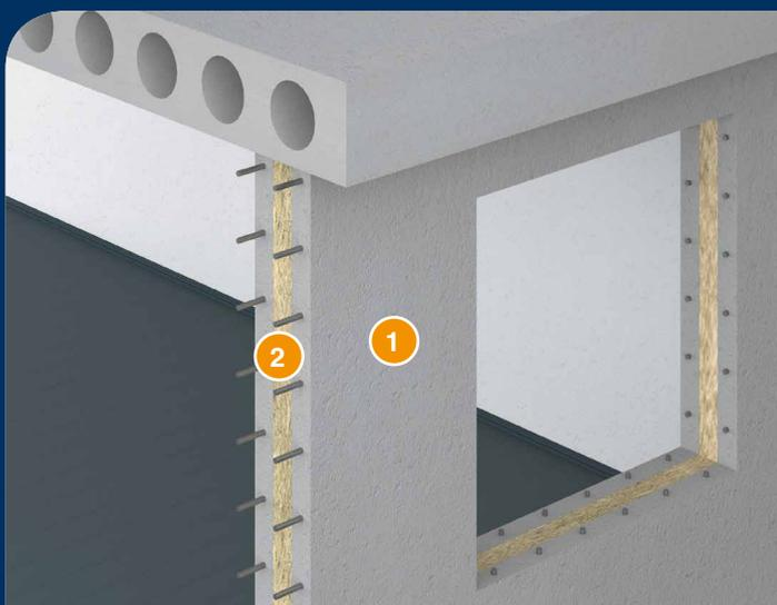
1. Железобетонная плита
