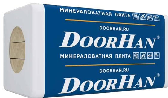
Плиты «Вент Оптима» применяются в качестве теплоизоляционного слоя в устройстве фасадных конструкций с вентилируемым зазором при однослойной изоляции и в качестве наружного слоя теплоизоляции при выполнении двухслойной изоляции.
