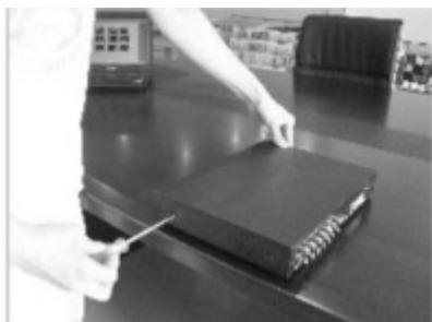
1. Удалить установочные винты для верхней крышки устройства
