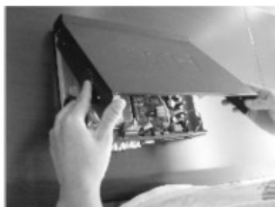
6. Закрыть крышку и зафиксировать ее болтиками
