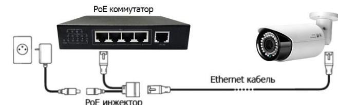
С целью безопасности необходимо обеспечить соответствующее заземление камеры. В случае однофазного заземления системы, импеданс системы должны быть менее 4 Ω, площадь заземления провода по земле должна быть более 25мм<sup>2</sup>.
