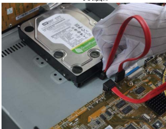
Подключите кабель данных и питания к HDD
