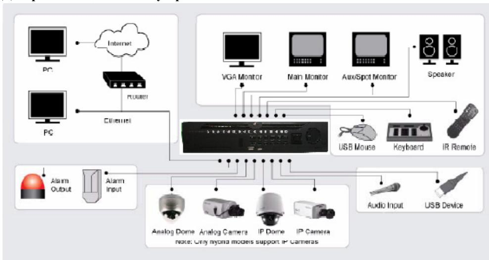
Рисунок 4. Диаграмма подключения устройства
