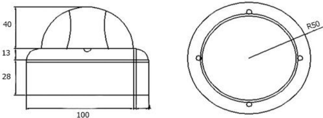
Монтаж видеокамеры необходимо производить на твёрдой устойчивой поверхности. Во избежание попадания влаги на разъёмы видеокамеры, рекомендуем использовать коммутационные коробки, со степенью защиты IP66.
