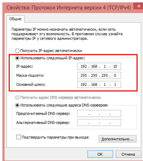
В поле IP-адрес ввести адрес одной подсети с IP-камерой. Например, если камера имеет IP-адрес 192.168.1.88, то сетевому адаптеру ПК можно назначить IP-адрес, к примеру, 192.168.1.10, маска подсети по умолчанию 255.255.255.0.
