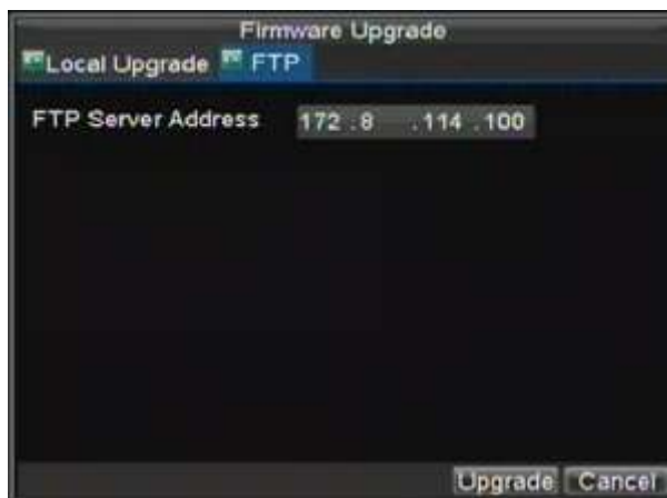
Рис. 12. Обновление устройства через FTP сервер
