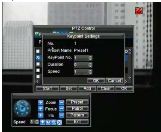
Рис. 6. Меню настройки точек обхода (патрулирования)
