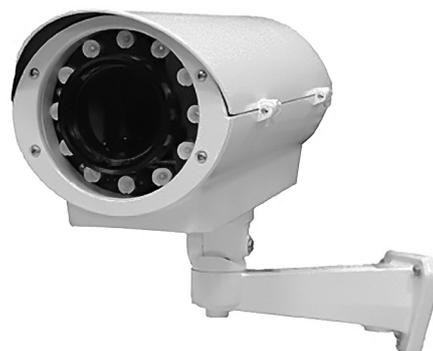
Термокожух STH-6230D-PSU2 с ИК-подсветкой – это оптимальный выбор для обеспечения работы телекамер («день/ночь» и черно-белых) в широком диапазоне температур при неблагоприятных погодных условиях. 12 мощных светодиодов оснащены широкоугольными и узкоугольными линзами для формирования равномерной диаграммы направленности, обеспечивая дальность подсветки до 120 м (реальная дальность действия подсветки зависит от чувствительности используемых телекамер).
