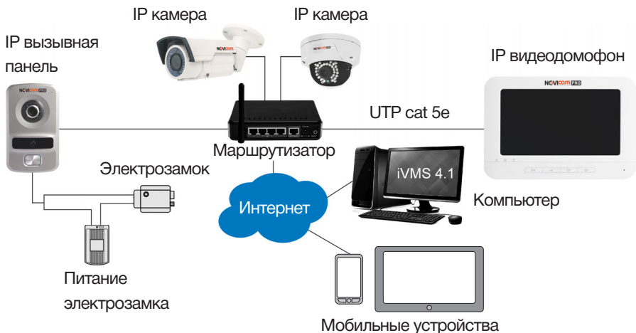
Рис.8 Пример схемы подключения NDM7F.
