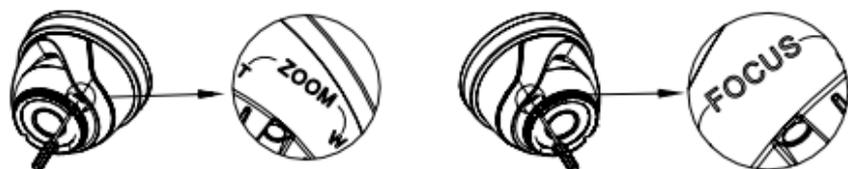
Рис. 5 Регулировка угла обзора камеры FC18W, FC28W.
