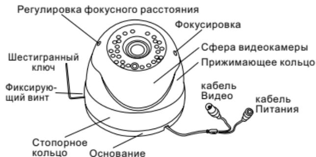
1. Выкрутите фиксирующие винты из отверстий при помощи шестигранного ключа (только для моделей с фиксирующими винтами).
