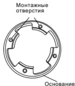
2. Удерживая основание камеры - и поворачивая стопорное кольцо против часовой стрелки - снимите его. Отделите сферу видеокамеры и прижимающее кольцо от основания.
