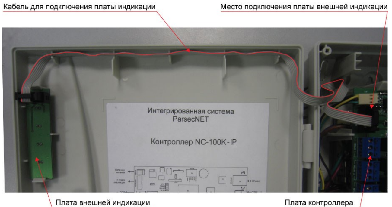
Рисунок 24. Схема подключения платы внешней индикации
