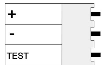
Рисунок 3. Назначение контактов разъема POWER
