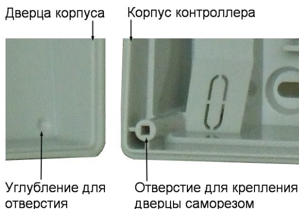
Рисунок 6. Схема «жесткого» крепления дверцы к корпусу контроллера
