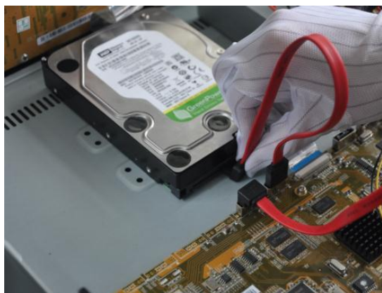
Падключыце кабель дадзеных і харчавання да HDD
