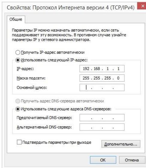
В поле IP-адрес ввести адрес одной подсети с IP-камерой. Например, если камера имеет IP-адрес 192.168.1.88, то сетевому адаптеру ПК можно назначить IP-адрес, к примеру, 192.168.1.1, маска подсети по умолчанию 255.255.255.0.
