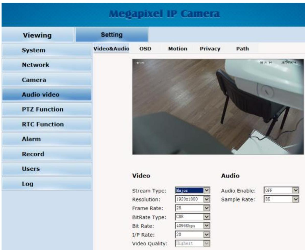
В пункте **Stream Type** выбирается поток (Major, Minor, Mjpeg) данная камеры поддерживает три потока. **Resolution** - выбор разрешения съемки. **Frame Rate** – Количество кадров в секунду. **BitRate Type** – тип битрейта. **Bit Rate** – битрейт.
