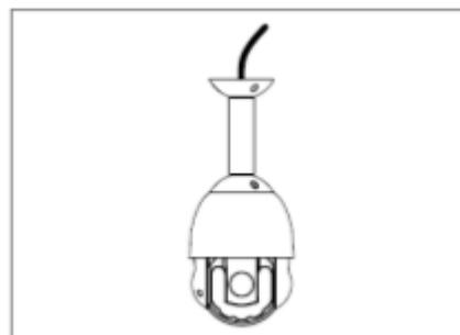
3. Надежно закрепите кронштейн камеры 4 шурупами из набора поставки на несущей поверхности.
