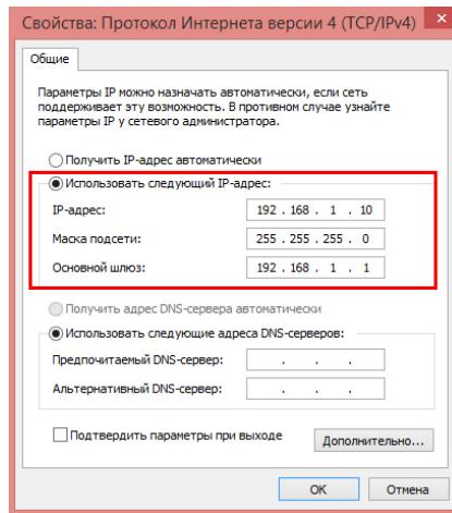
В поле IP-адрес ввести адрес одной подсети с IP-камерой. Например, если камера имеет IP-адрес 192.168.1.18, то сетевому адаптеру ПК можно назначить IP-адрес, к примеру, 192.168.1.1, маска подсети по умолчанию 255.255.255.0.
