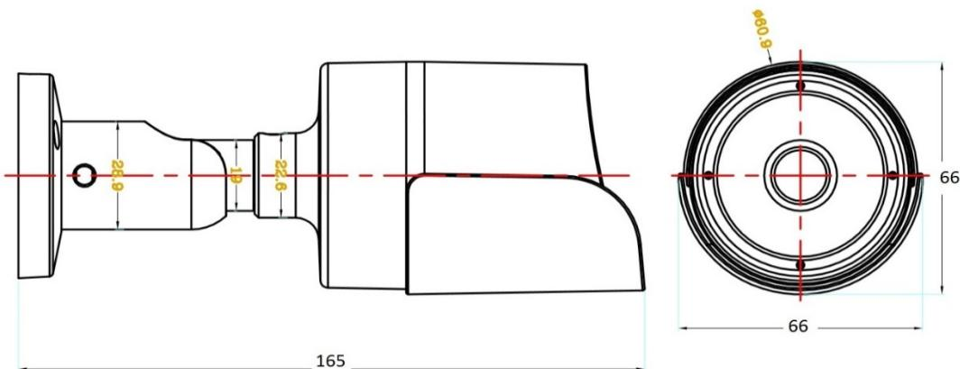
Монтаж видеокамеры необходимо производить на твёрдой устойчивой поверхности. Во избежание попадания влаги на разъёмы видеокамеры, рекомендуем использовать коммутационные коробки, со степенью защиты IP66.
