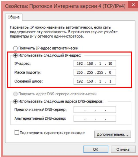
В поле IP-адрес ввести адрес одной подсети с IP-камерой. Например, если камера имеет IP-адрес 192.168.1.88, то сетевому адаптеру ПК можно назначить IP-адрес, к примеру, 192.168.1.10, маска подсети по умолчанию 255.255.255.0.
