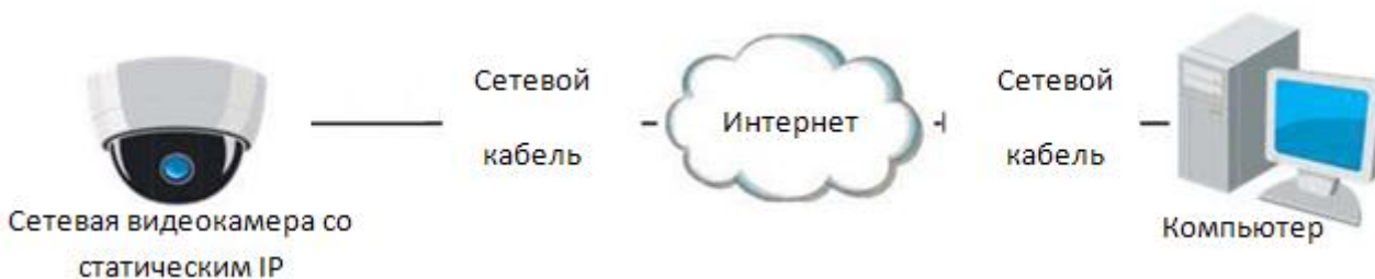
Рисунок 3.4.1: Доступ к сетевой камере со статическим IP напрямую (без использования дополнительного сетевого оборудования).
