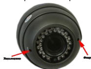
Шаг.5 Отрегулируйте угол обзора и фокус используя винты регулировки, после регулировки необходимо вставить в отверстия заглушки из комплекта поставки.
